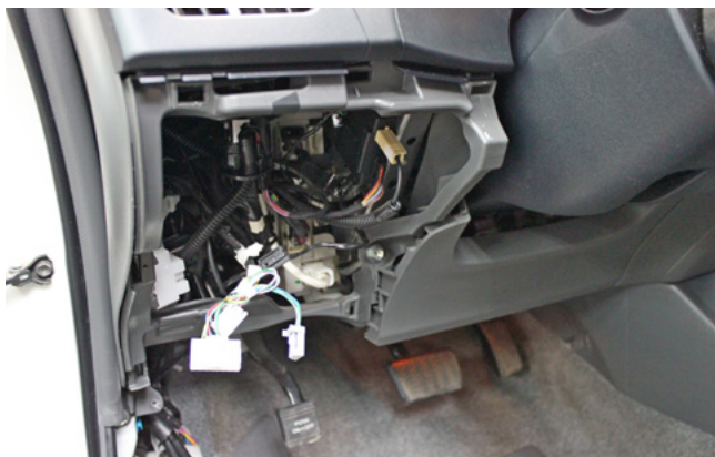
Фото 1.7. Накладка слева от рулевой колонки снята
