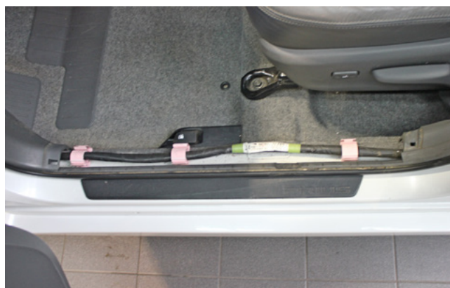
Фото 1.2. Накладка порога снята
