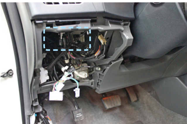
Фото 2.6. Пример расположения центрального блока охранно-телематического комплекса
