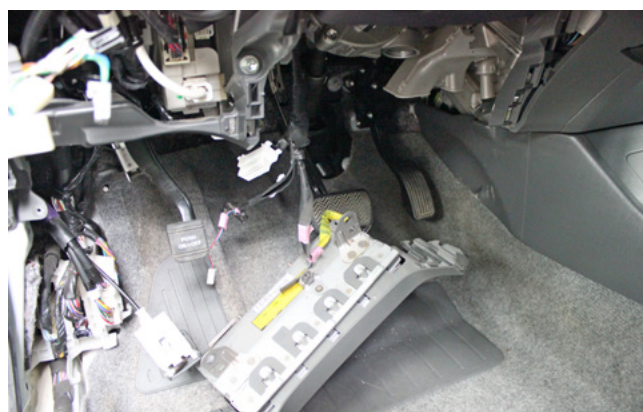
Фото 1.12. Подушка безопасности снята
