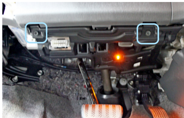
Фото 1.8. Саморезы крепления накладки педального узла
